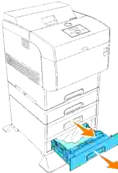
2. Entfernen Sie das gesamte gestaute und/oder zerknitterte Papier aus dem Papierfach.
