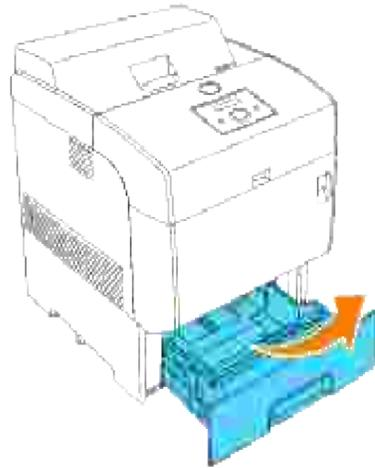
2. Entfernen Sie das gesamte gestaute und/oder zerknitterte Papier aus dem Papierfach.
